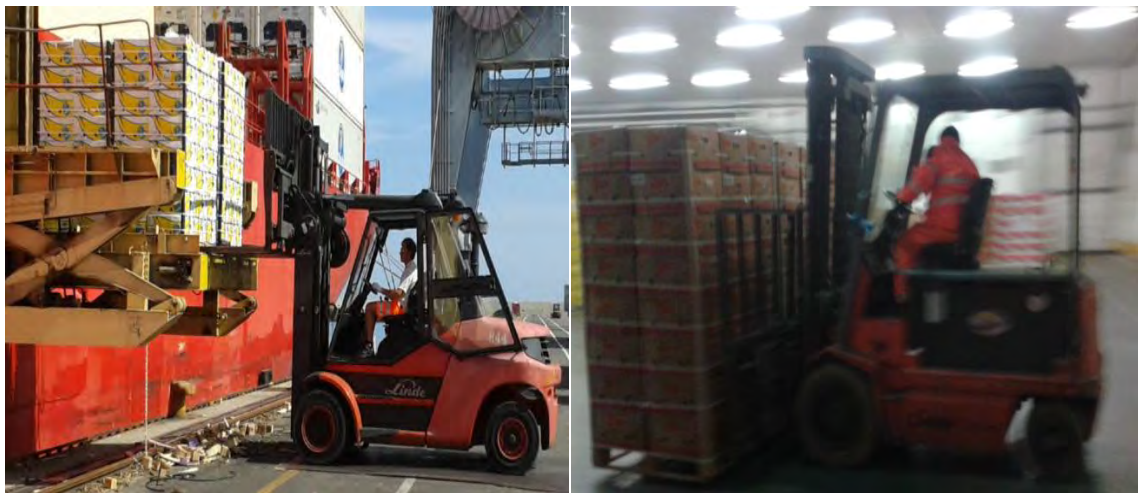
Fig. 2.5 - A sinistra un fork lift diesel, a destra un fork lift elettrico
