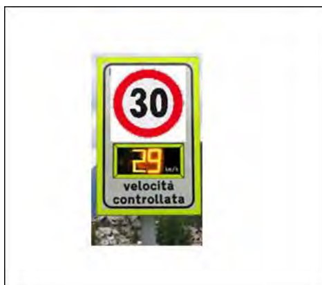
Fig. 4.14 - Esempio di rilevatore di velocità in un sito APM Terminals
