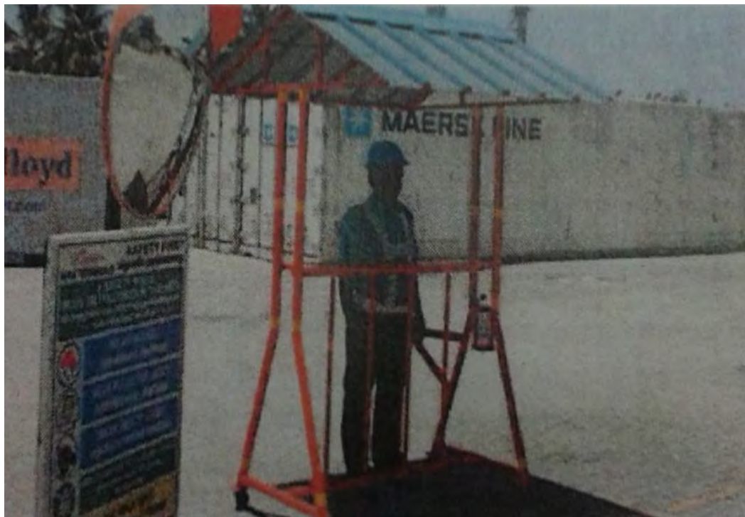
Fig. 4.17 - Esempio di postazione fissa di protezione per il segnalatore in un sito della APM Terminals
