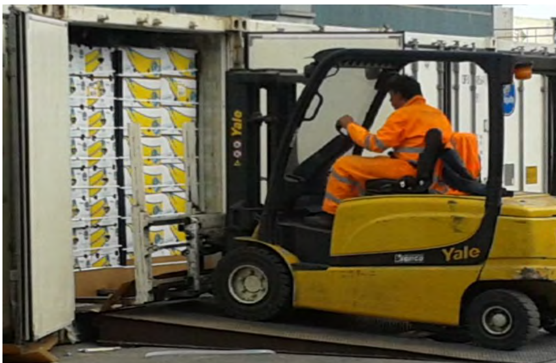
Fig. 2.9 - Operazione di svuotamento di un container reefer con fork lift diesel nell'area prospiciente il magazzino
